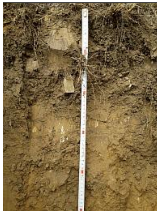
Deluviální vrstva nevhodná k zakládání bez úpravy (interval 0,25-0,5 m)
